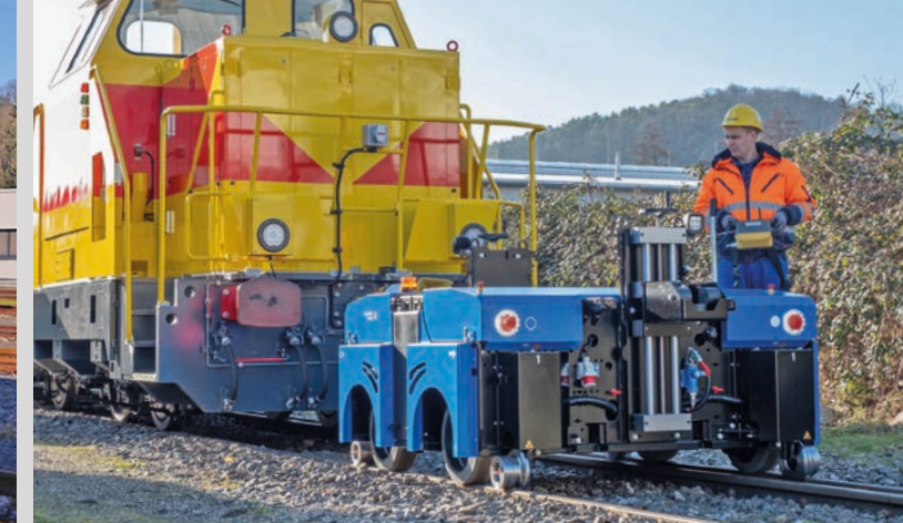
ZAGRO E-MAXI M com receptor de acoplador ajustável em altura ZAGRO E-MAXI M with height adjustable coupler receiver
