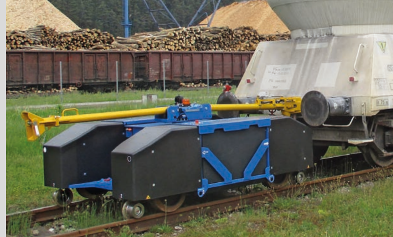
ZAGRO E-MAXI L com acoplamento tipo duplo ZAGRO E-MAXI L with twin-type coupling bar receiver
