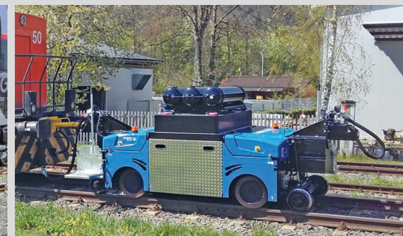
ZAGRO E-MAXI XL com sist.de frenagem de vagões e ponto de apoio ZAGRO E-MAXI XL with wagon brake system and foothold
