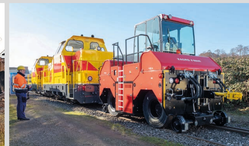
ZAGRO E-MAXI XXL com controle remoto por rádio ZAGRO E-MAXI XXL with radio remote control
