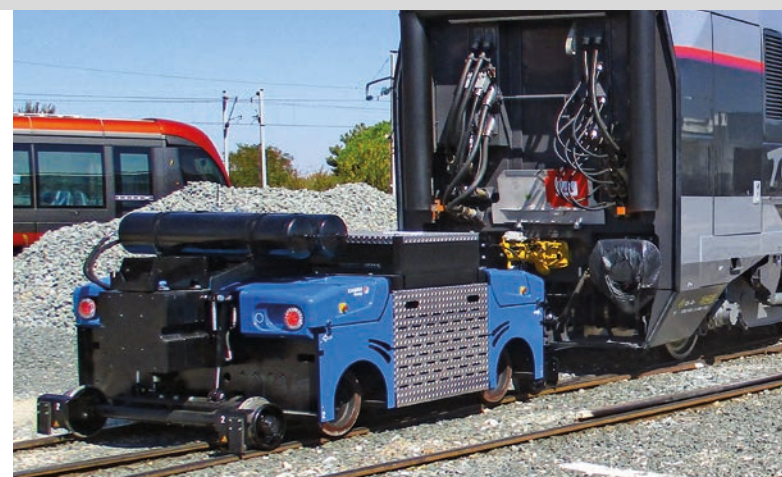
ZAGRO E-MAXI XL com sistema de frenagem de vagões ZAGRO E-MAXI XL with wagon brake system
